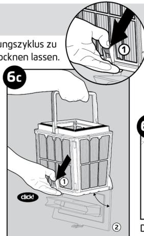
Den Riegel öffnen, um den unteren Deckel freizugeben und eventuelle Verunreinigungen zu entfernen.
